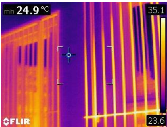
Foto 4: Es wird bestätigt, dass mögliche Energieverluste zwischen Fenstern/Türen und Umfassungsbauteilen vernachlässigbar sind und dass an den Außenwandflächen eine thermische Kontinuität besteht (Westfassade).
