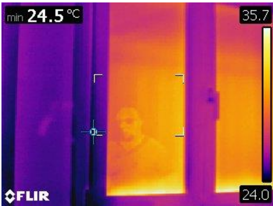
Foto 3: Es werden keine nennenswerten Wärmebrücken an den Anschlüssen zwischen Fenstern/Türen und Wandflächen festgestellt (innen).
